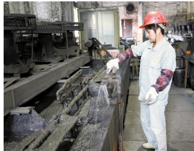
天马山矿业公司金口岭选矿车间职工国庆节长假正在检修球磨机。金口岭选矿车间针对设备状况，利用国庆长假，对节日期间生产和设备检修合理安排，一方面对处理炉渣的1号球磨机实行正常生产，另一方面，对处理自产矿的零号球磨机实行停产检修，全面更换衬板，较好地保证了国庆长假期间生产平稳过渡。
