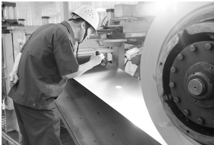
金威铜业公司板带分厂职工日前正在查看650清洗线上板带清洗效果。金威铜业公司650清洗线为引进日本生田公司的全进口设备，其研磨刷辊工作时振动严重，造成铜带表面有明显振纹，影响带面质量。针对这一问题，该公司技术人员经过分析，不断摸索，对清洗设备作了增大铜带与研磨刷的包角，减少刷轴与传动轴的工作夹角等技术改进，使得研磨机振动显著减小，铜带表面的可见振纹基本消除，提高了板带表面质量，满足了高端电子铜带的生产要求。通过技改，由此带来公司产品成品率提高，年创效益336万元。该项技改为此还获得了2014年度集团公司职工合理化建议和技术改进成果一等奖。
