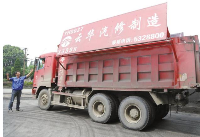
8月18日，安庆铜矿拉运铁精砂的货车正在启动安全环保盖，该矿于近期投入一定资金对所有货运车辆货箱安装了环保清洁盖，杜绝了车辆行驶途中精砂产品的泼洒和流失，实现了环保运输。杨勤华 摄
