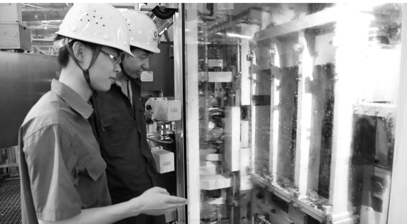
金威铜业公司职工日前正在运行中的轧机尾气分离排放装置巡视。轧机在轧制过程中会产生大量的油气混合气体,如果直接排放,既影响环境,又会造成极大的浪费。该公司采纳职工合理化建议,去年对轧机尾气分离排放装置成功进行技术改造,使油液回收率达到97%至99%,符合了国家尾气排放标准。通过这项技术改造,不仅减少了对环境的污染,每年还因油液回收创效32万元。
