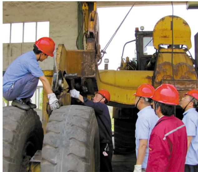
日前,铜冠物流公司金冠车队针对一台进口渣罐车翻转轴承出现了轴承套损坏的故障,车队立即组织维修人员全力进行抢修,以确保渣罐车正常运行。图为维修人员正在更换轴承套。王树强 章红海 摄
