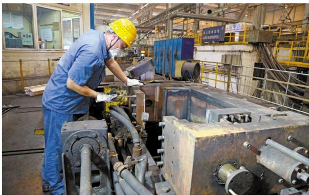
金威铜业公司职工目前正在无氧铜炉前保养全连续结晶器。无氧铜炉是金威公司重点生产紫铜铸锭炉,无氧铜炉铸锭氧含量决定铸锭品质和品位。为控制铸锭氧含量,该公司熔铸分厂技术人员针对无氧铜炉结晶器提出合理化技术改造建议,并通过地采用全新的全连续结晶器替代半连续结晶器完成了改造。该项技术改造不仅使铸锭成品率明显提高,还创造了显著的经济效益,并因此荣获了集团公司2014年度合理化建议和技术改进成果一等奖。王红平 黄军平 摄
