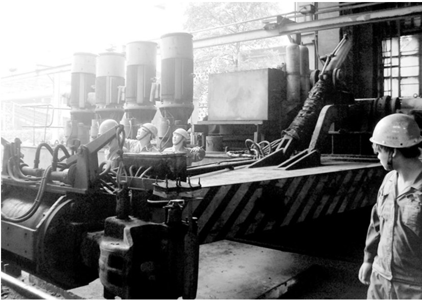
马钢焦化公司新区分厂始终把环保作为重中之重,在强化职工环保意识的同时,严格生产工艺流程环境治理整顿,及时杜绝跑、冒、滴、漏现象发生。图为检修人员正在认真更换装煤设备。赵春阳摄
