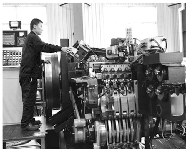
近日，秦皇岛齐燕数控机床有限责任公司研发制造的BP-440SS型螺旋自动墩锻机已顺利下线，目前正在稳定试验，将于下半年开始批量生产。
