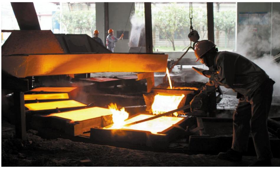
经过历时两个多月的奋战,5月26日8时58分,张家港铜业公司生产中心精炼车间新2号阳极炉技改后顺利产出第一炉铜水,浇铸出第一批合格阳极板。此次技改对炉体结构和生产工艺进行了进一步优化,单炉产量达到210吨,较改造前单炉产量提高近一倍,主要生产工艺参数和主体设备运行正常,安全环保均符合设计要求。
