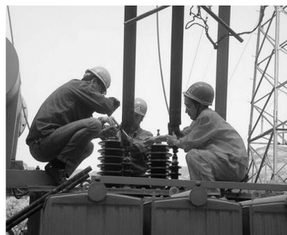
日前,凤凰山矿业公司机运车间供电班利用晴好天气完成了对35千伏变电所1号主变压器的绝缘耐压试验和负240米中段配电所高压开关柜预防性试验等工作,为井下防洪防汛期间的供电安全提供了有效保障。图为专业人员在做主变压器的高压绝缘试验。
