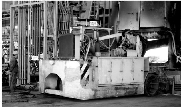
张家港联合铜业公司废杂铜再生综合利用一期工程精炼摇炉系统正在进行炉前加料。这个公司精炼摇炉系统自2014年11月7日一次性重负荷联动试车成功以来，通过进行技术革新和改造，各项技术指标不断优化。天然气单耗由改造前的85吨铜每立方米下降到现在的63吨铜每立方米，降幅达38%，大大降低了运行成本。王松林 杨学文 摄
