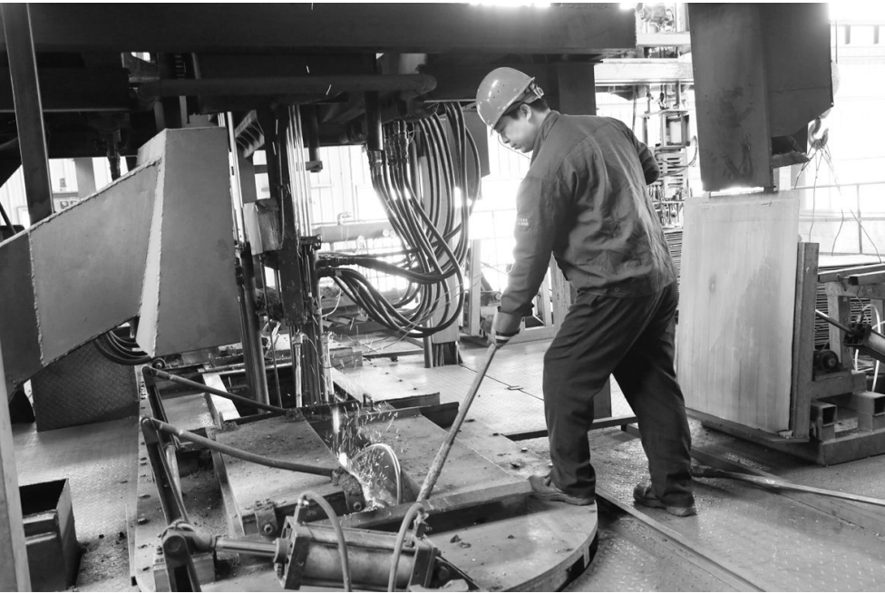
铜冠电工公司磷铜分厂职工目前正在改造后的国产联体炉前作业。该公司通过对磷铜分厂国产联体炉炉型结构优化改进,将熔化炉、保温炉并列布置改为保温炉居中、双熔化炉两侧对称布置,使得保温炉内铜液温度稳定,温差小,减少了表面氧化、裂纹、断杆等缺陷,磷铜杆产品合格率由98%提高到99%。同时,还降低了电单耗,提高了生产能力。
