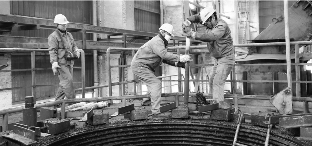
稀贵金属分公司渣选矿车间破碎系统日前正在检修。该公司抓住选矿车间 2 月份顺利完成生产的时机,利用 2 月末和 3 月初的短短几天时间,组织职工配合外协施工队伍,对破碎机等重点设备开展短平快式的检修,以此为进一步破碎及渣选生产创造有利条件。
