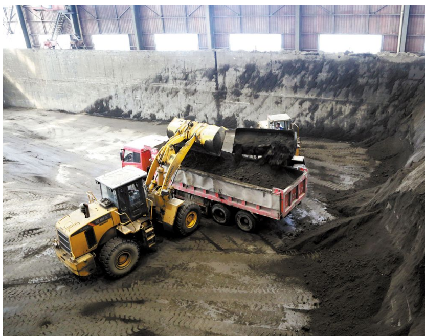
稀贵金属分公司渣选车间正在倒运尾矿。开年以来,该车间通过精心做好生产组织安排,加强岗位员工操作控制,特别是春节长假期间,车间组织职工正常生产,确保了生产的平稳有序。今年前两个月,该车间处理共炉渣172396吨,同比增长16.39%,呈现出良好的生产态势。 王红平 章庆 摄
