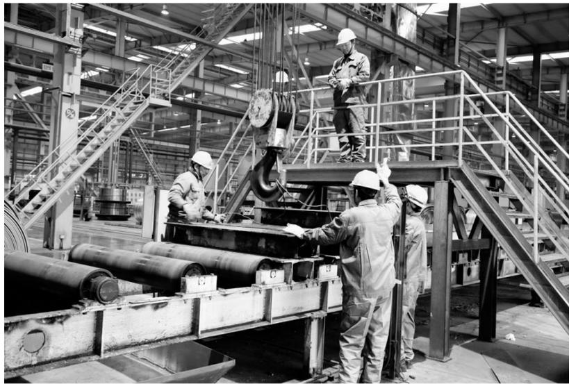
金威铜业公司充分利用春节期间加工量小以及春节放假的时机,及时组织设备大修,为全年生产创造良好的设备状况。为此,春节期间,该公司先后对步进炉、1250气垫炉、热轧机、铣面机、粗轧机、无氧铜炉加料线等设备进行停工大修。由于工期紧,施工程序复杂,大部分干部职工放弃春节休假,坚守在车间大修现场。图为该公司热轧系统辊道的大修场景。
