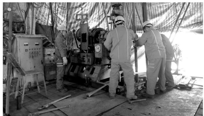
面对2015年任务重、重点难点工程多的形势,矿产资源中心合理调整生产计划和机台配置,对重点工程和深孔实行全程跟踪,加强生产作业计划的指导性。图为该中心铜山矿施工现场,机台工作人员正在进行加杆作业。傅大伟 萨百灵 摄
