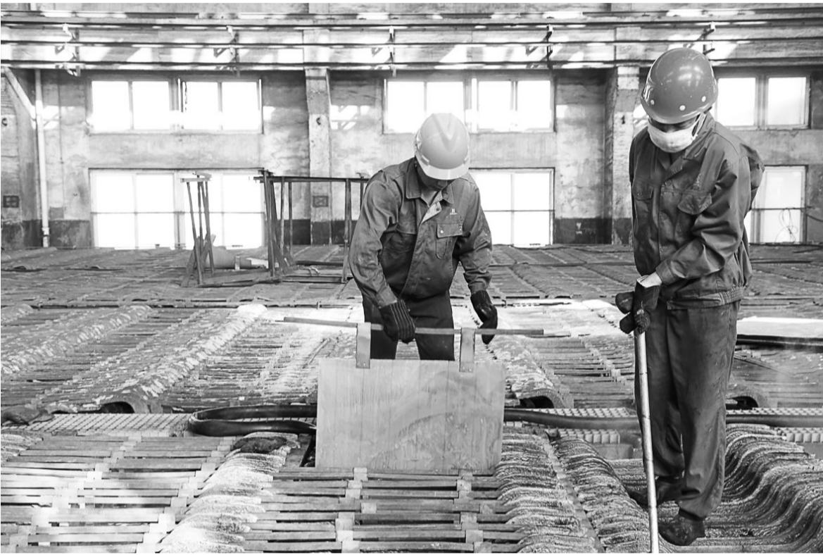
金昌冶炼厂电解车间职工日前正在槽面精心作业。金昌冶炼厂在新年电铜生产质量控制上,通过合理改进工艺,严格标准化操作,并按工序从阳极片生产、剪边、校平、加工到电解槽面的查补残极、升降电、电煮洗,确保了电铜物理规格和化学品位达标,电铜质量持续稳步提高。新年第一个月,该厂高纯铜产率达到了99.55%,创造了近年来最好水平。 王红平 齐宏明 摄
