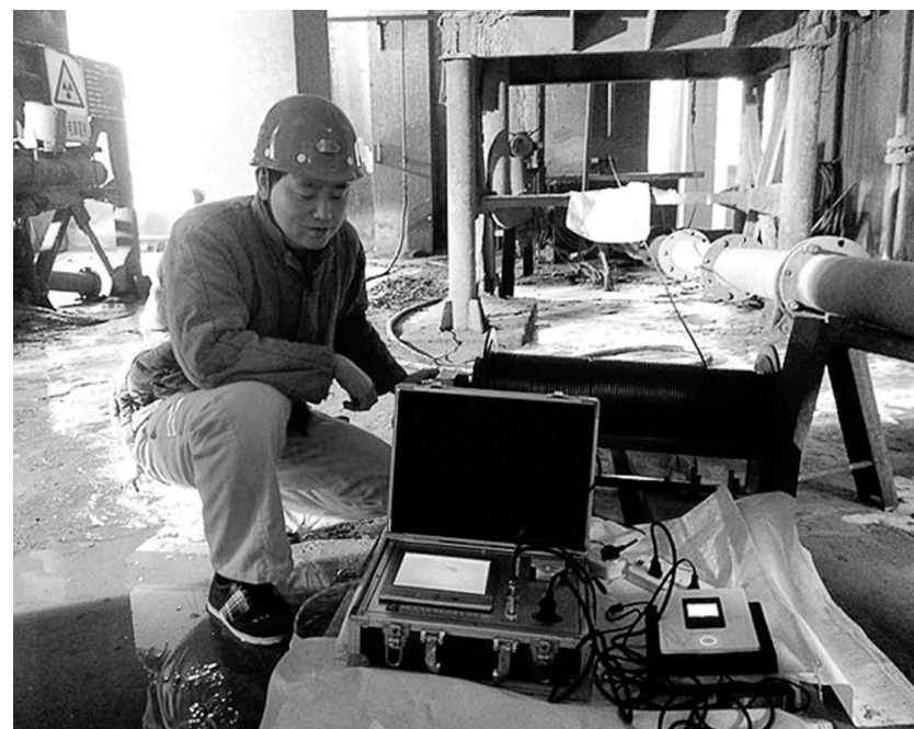
为掌握井下充填钻孔磨蚀及变化情况，冬瓜山铜矿充填区利用检修停产时机对井下负280中段至地表的2号、5号、6号三套充填钻孔进行了安全检测。此次钻孔检测采用较为先进的深孔视频技术，不仅可以现场直观显示数百米高钻孔内壁状况，还可以将检测结果刻录成影像资料，为后续安全生产提供详实的视频依据。图为该区工作人员正在操作视频检测设备。
