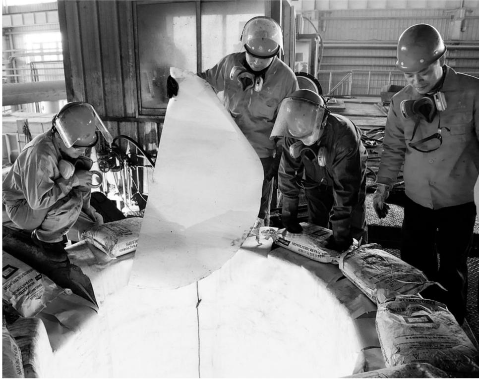
元月1日，铜陵有色铜公司熔铸车间职工正在筑炉作业。为改善无芯炉炉况，为新年加工生产提供优质的铸锭，新年第一天，熔铸车间职工将无芯炉进行了拆除，并重新筑炉，确保新筑的无芯炉能更好地投入生产。
