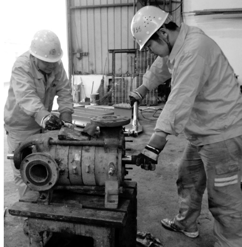
为不断提高职工维修技能,提升节约意识,冬瓜山铜矿提升一区开展修旧利废活动。活动开展以来,共修理废旧电焊机 2 台、电动机 2 台、液压油缸 5 个,井下负 1025 米水泵 4 台、液压站 2 台,节约备品备件及材料成本约 6 万元。图为职工正在修理下水泵。廖友健 摄
