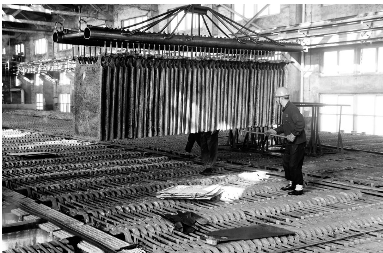
金昌冶炼厂电解车间职工正在下槽前整理阳极板。去年下半年以来,金昌冶炼厂电解车间以电铜质量为中心,开展并实施了加强添加剂使用管理,强化标准化作业,及时采取应对当前电解液成分变化对电铜质量造成的影响等多项举措,推动电铜质量和产量均取得较好成绩,并创造了当前高纯铜产率 98.74% 的新高。
