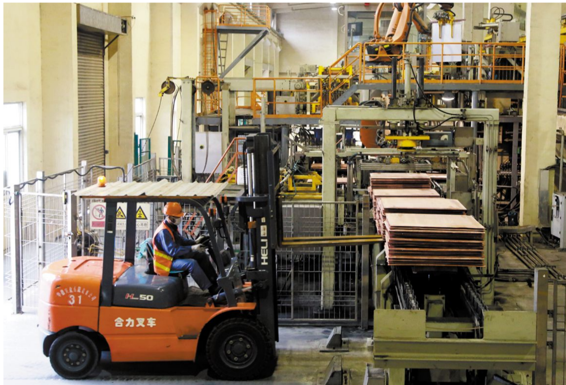
金冠铜业分公司电解车间内电铜正在下线。在过去的一年里,金冠铜业分公司利用首次设备大修契机,加大设备管理,抓好生产操作,生产实现稳步中增长,电铜产量不断攀升,技术指标持续优化,为新的一年实现达产达标打下了坚实的基础。 王红平 汪秀志 摄
