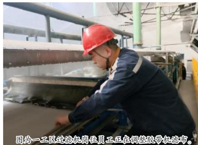
图为一工区过滤机岗位员工正在调整胶带机滤布。
