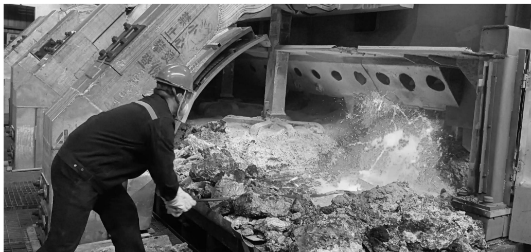
电解厂电解工在摄氏100多度的电解槽前对临极进行抗氧化处理。
