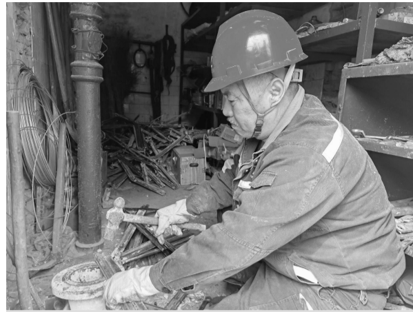
3月份以来,资源综合利用分公司分解工区把“修复废旧卡子”作为日常工作来抓,组织基层骨干利用工作之余,逐件清理废旧卡子结垢、锤打整形。仅3月份,就修复滤板卡子140件,节约成本6000余元。图为员工正在修复变形的滤板卡子。 摄影报道 柴菊珍
