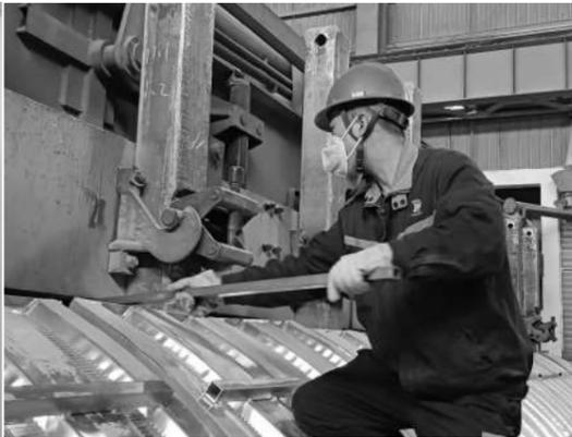
为迎接B类企业验收，近期，电解厂加强现场整治，做到高标准清理。在清理槽上部设备及槽洞物料时，由于缝隙小很难清理，该厂研究制作了专用清理工具，经过半个月加班加点的工作，520台电解槽已全部清理完毕，共清理物料300余吨，并直接返流程使用。图为员工正在清理槽洞物料。
