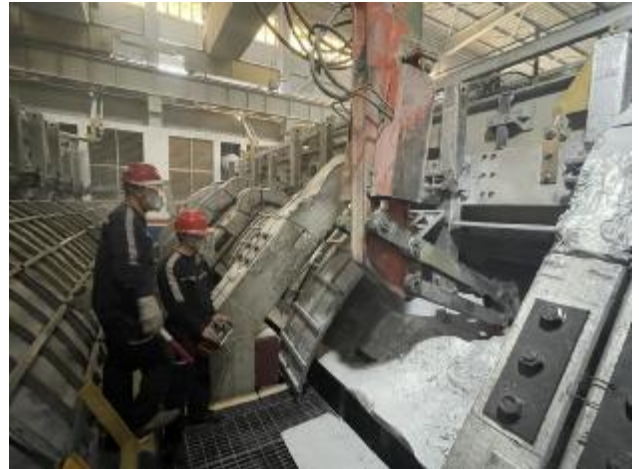
为推进全要素对标工作,近日,电解厂电解一车间党支部以“两带两创”活动为载体,通过与先进标杆对标,设立了“降低车间综合交流电耗”课题。课题实施以来,党员冲锋在前,带头攻关,通过低平均电压、降低效应系数、提高电流效率和操作质量等一系列措施,综合交流电耗较上月降低19Kwh/t.AL。图为党员干部冲锋一线,开展换极作业。摄影报道 汪丽丹
