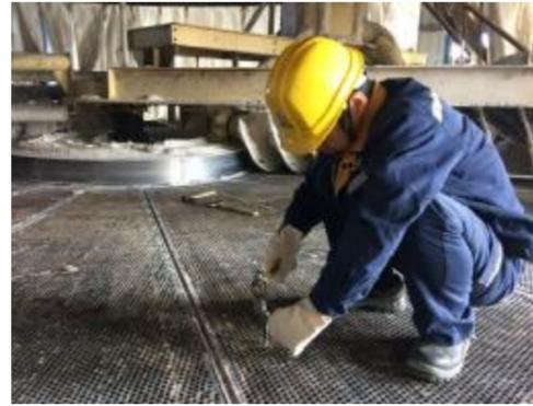
近日,为了加快焙烧炉系统检修速度,第二氧化铝厂组织党员骨干力量,利用周末休息时间,对焙烧工区平盘扇形板清理整治。参战员工利用小锤、自制的改锥等工具,耐心细致地对孔眼、压槽结疤进行逐一疏通,4小时时间里,共完成了6号平盘上千个孔眼的清理任务。图为党员突击队正在清理平盘。
