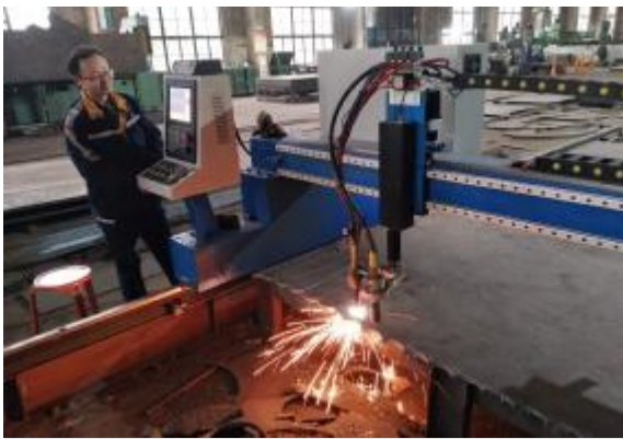
近日,山西中铝铝工服公司机械制造厂采购了一台数控等离子切割机,该等离子切割机有效提高了非标异形件的加工能力和效率,满足了客户需求。摄影报道 郝华云 丁庆江
