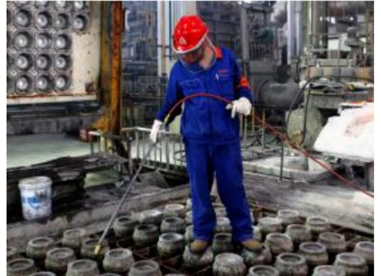
近日,中铝山西新材料公司铸造厂强化安全质量工作,从基础管理、现场管理等17个方面进行梳理,通过严格管理、强化约束力,不断提升员工安全生产意识和精细操作水平。图为做好铸造前的准备工作吹引锭头,防止热铝进铸盘后发生事故。摄影报道 陈小萍
