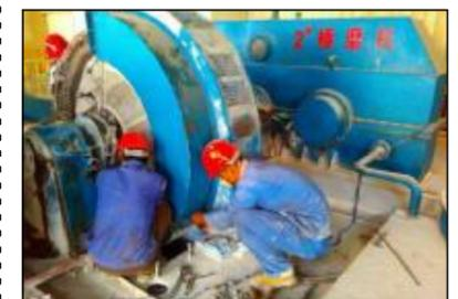
山西中铝工业服务有限公司电器安装检修施工处电机一班主要负责氧化铝一厂、二厂及热分厂100KW以上电机的维护、保养、大修与更换工作。
