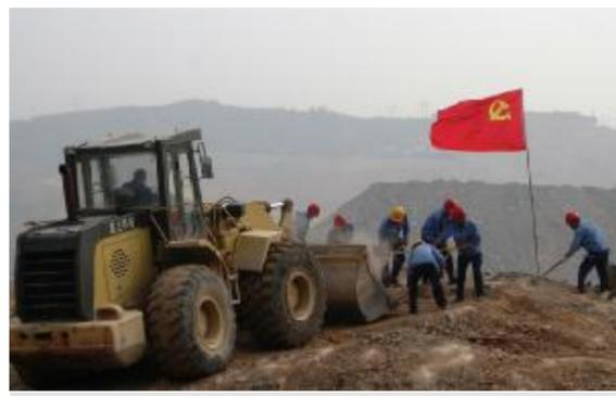
近日,石灰石矿出动挖掘机、装载机等大型设备对西采场的804台阶进行彻底清理,3天共清理废石、土块1000余吨,有效阻止了不合格矿石进入生产线,提升了矿品合格率。摄影报道 石雷
