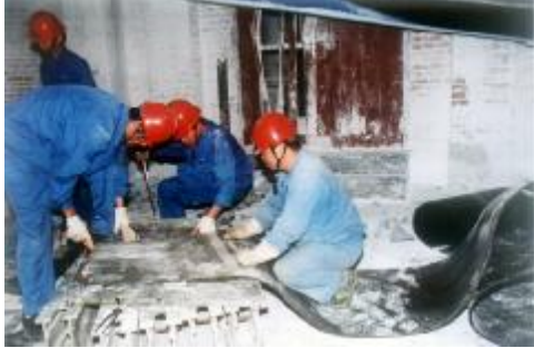
氧化铝厂焙烧车间为质保每天3300吨成品氧化铝的正常输送，员工们加班加点对200多米长的B707皮带进行更换。图为员工在粘接皮带接头。杨道军 摄
