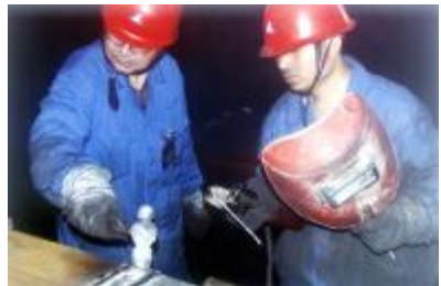
碳素厂二组装车间对于设备故障历来坚持早发现的原则,降低了事故发生率。图为车间组织人员修理断裂的阳极组装台。(陈伟 摄)
