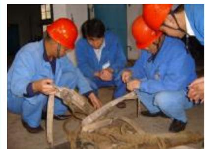
为保障今年“双过半”供电线路大修工作的顺利进行，一矿机电车间组织安全员、技术员、青安岗监督员对电工登高作业使用的吊绳、踏板、安全带、脚扣进行检查。(燕黔红摄)
