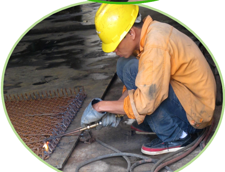
上图为员工在改造筛网,以此来降低破碎的出矿粒度,提高处理量。
