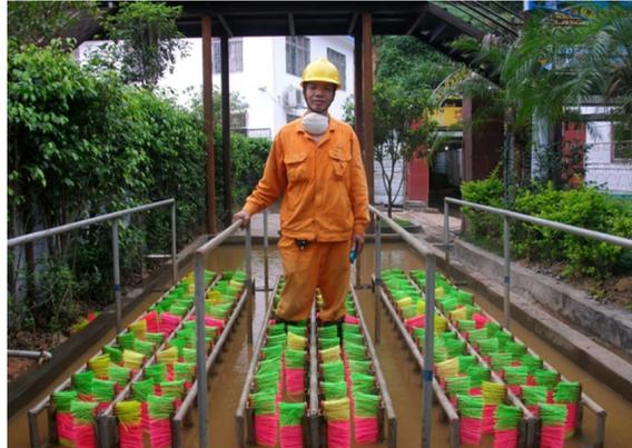
本报讯 近日,古益矿自制的井口洗鞋池(见上图)正式投入使用。行走在洗鞋池上,“刷刷刷”在两排大刷子的运作下,水鞋上的泥土纷纷掉下。洗鞋池人性化的设计及干净有效的洗鞋效果得到了广大员工的认可。此前,井下作业员工每次下班出井时,水鞋上总是沾满了泥巴,他们常常需要排队轮流到水龙头底下,借助手
