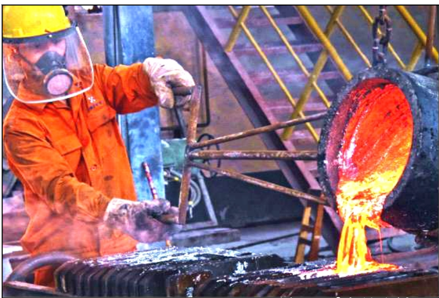
图为工人正在浇筑银合金板
