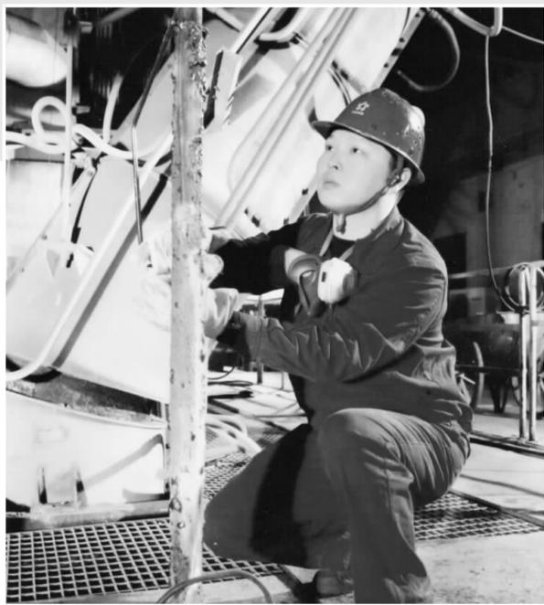
▲邵志村测量电炉总液面、冰铜面。
