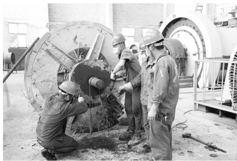
▲铜山口矿选矿车间职工们在改进维修分级机叶片。
