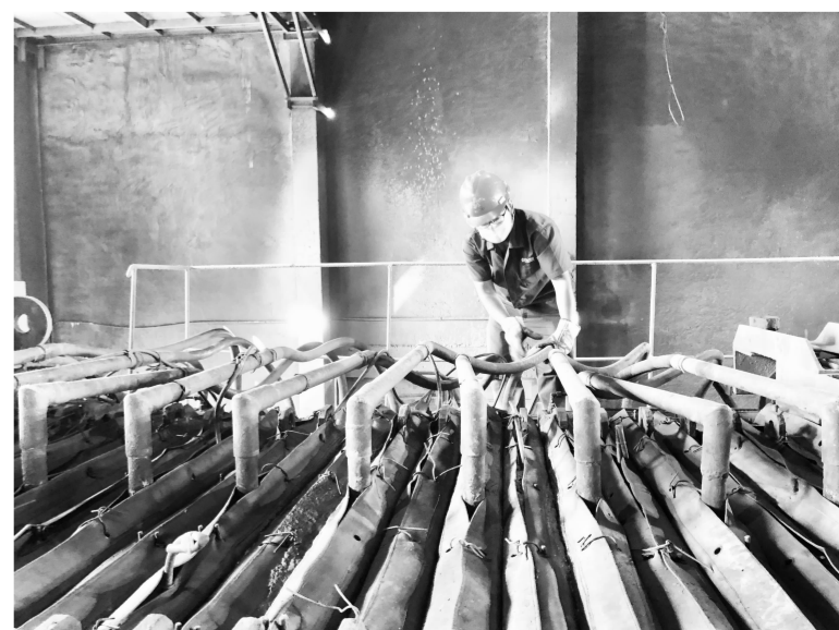
▲铜山口矿选矿车间职工在调整压滤机滤布等部件位置方便设备运行。
