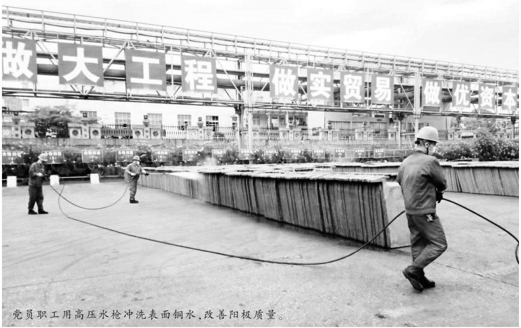
党员职工用高压水枪冲洗表面铜水,改善阳极质量。
