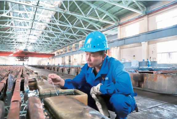
党员班长在测量电解槽温度。
