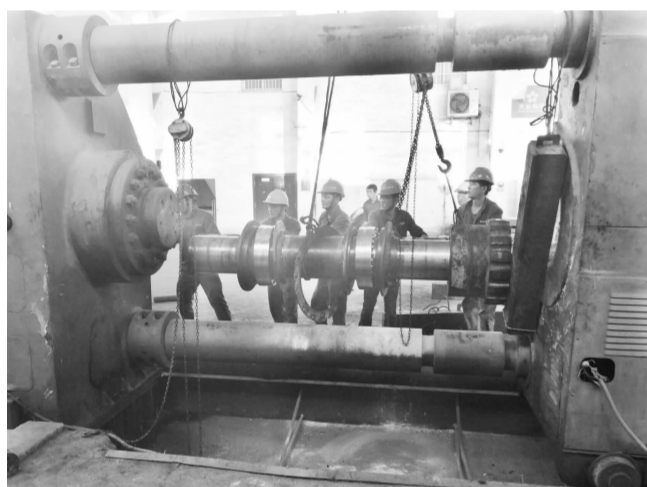
维修班在装配球磨机主轴。
