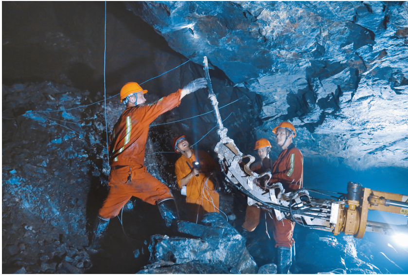
▲ 铜绿山矿职工在9311采场精心操作中深孔装药。
