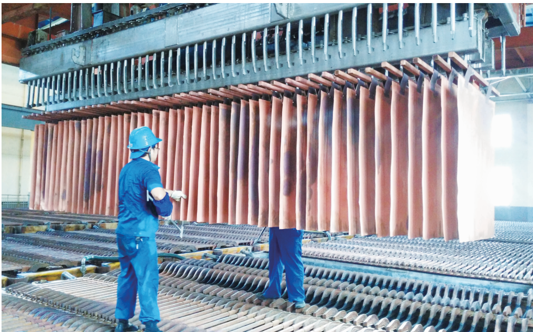
冶炼厂电解车间职工在闷热的电解槽上校直阴极片。(吴开凡 摄)
