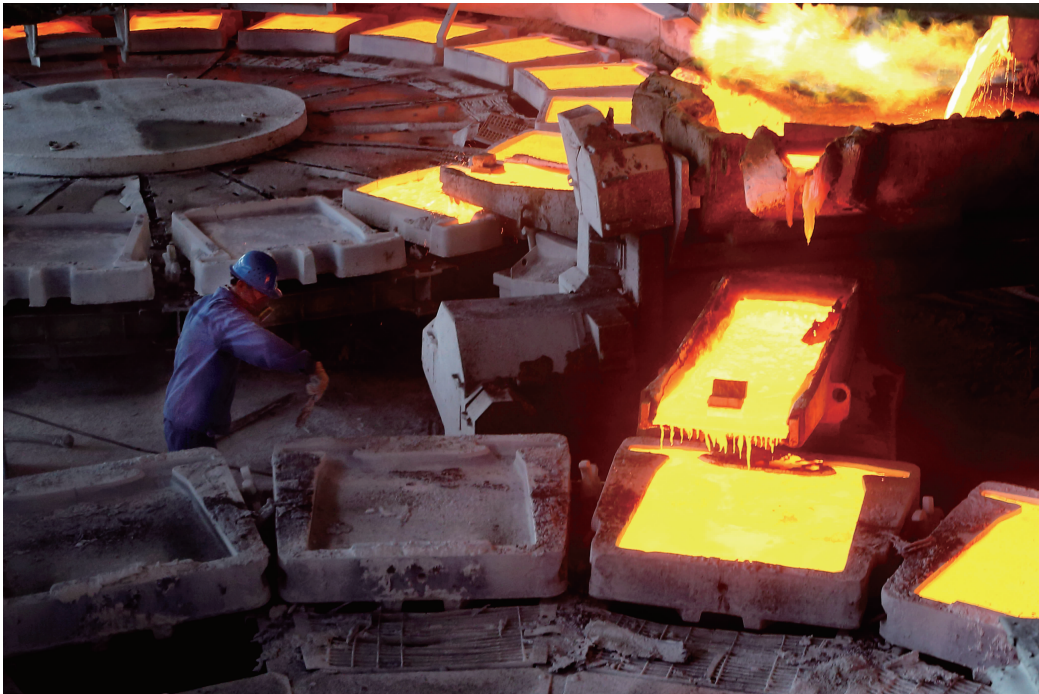
冶炼厂转炉车间精炼工浇铸阳极板。(陆军 摄)
