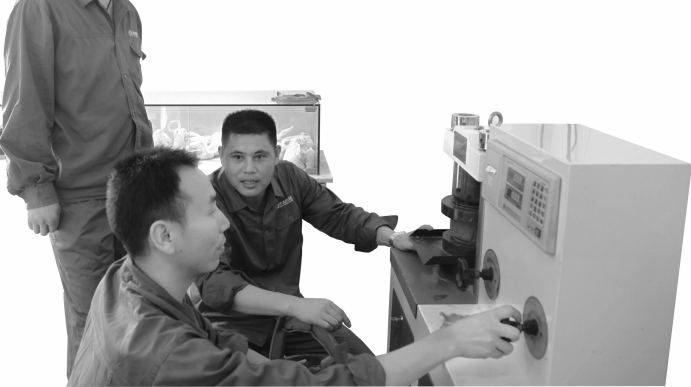
▲充填车间技术攻关小组进行固化剂制样模块抗压强度实验。
