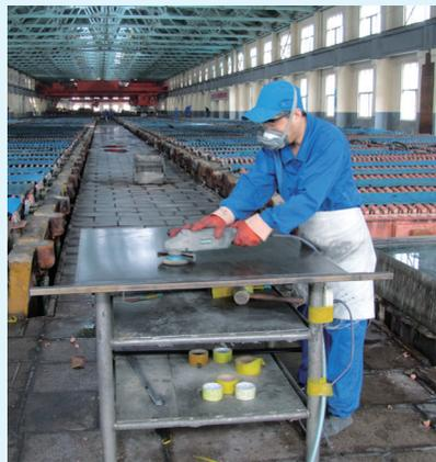
套管防护。此方案经过实施证明减少了磨损，打磨机的寿命真的延长了。日常作业中，作业人员还可以根据外观磨损情况，随时进行更换，操作简单密封性好。这样一来设备遇到腐蚀问题，再也不发愁了，“闹心事”迎刃而解。“你别说，‘给打磨机穿上防护服’这个小改善成本低、安装简单，既保障了用电安全、节约成本，又降低了职工的劳动强度，值得点赞！”打磨人员也竖起了大拇指，可谓是在其位，显奇效，人人称赞！
