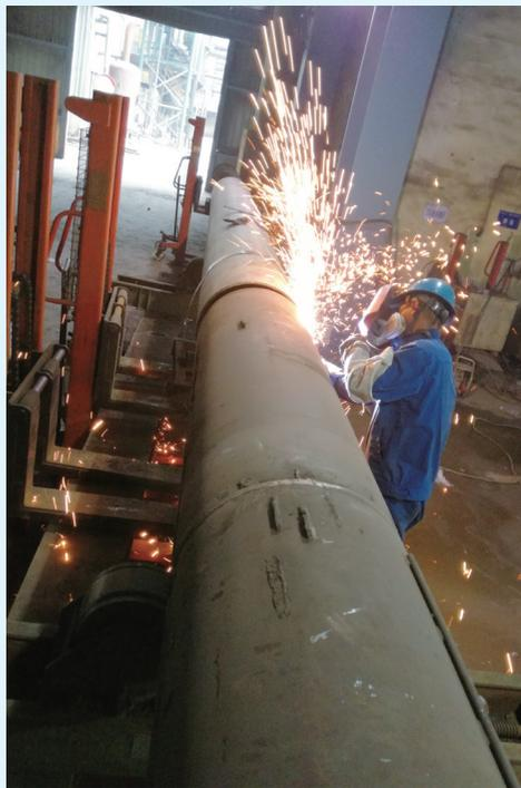
焊工正在维修喷枪。
