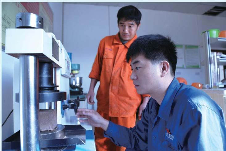
充填车间党员在进行充填模块抗压强度试验
