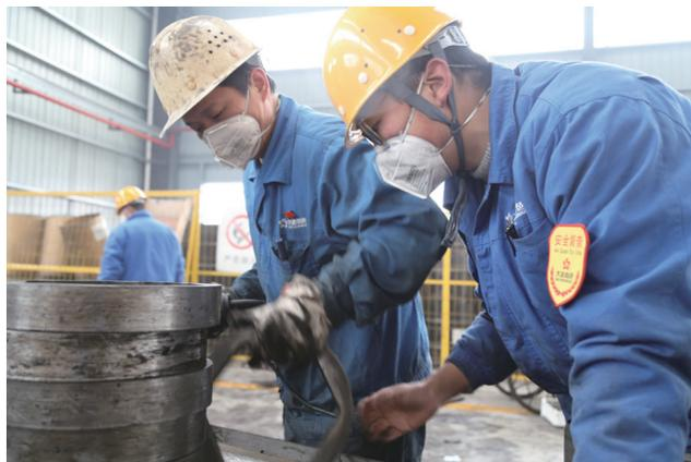
经过对冰箱处理设备更换刀具、滚轴等主要零部件维修后，1月8日，废旧冰箱无害化处理设备进入试生产阶段。 **(周梦)**
