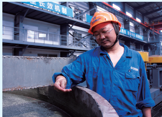
职工金红闯手摸磨矿细度,保障浮选精矿品位和回收率。
