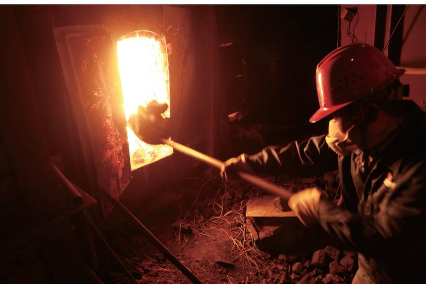
陈敬强往干燥窑中加入煤炭，通过干燥除去铸件砂型里的水分。
