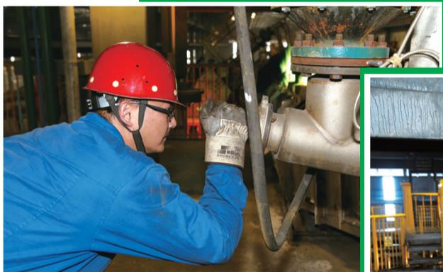
操作工观察竖炉炉膛内铜料熔化情况。
