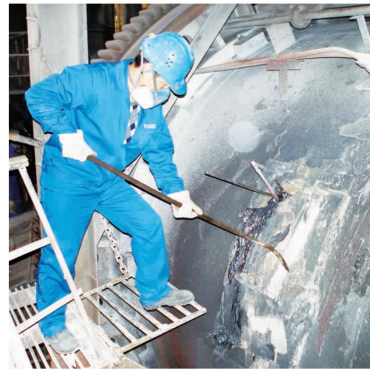
▲ 该车间职工正在清理出铜口杂物,对保护装置进行检查。 黄琨 摄
